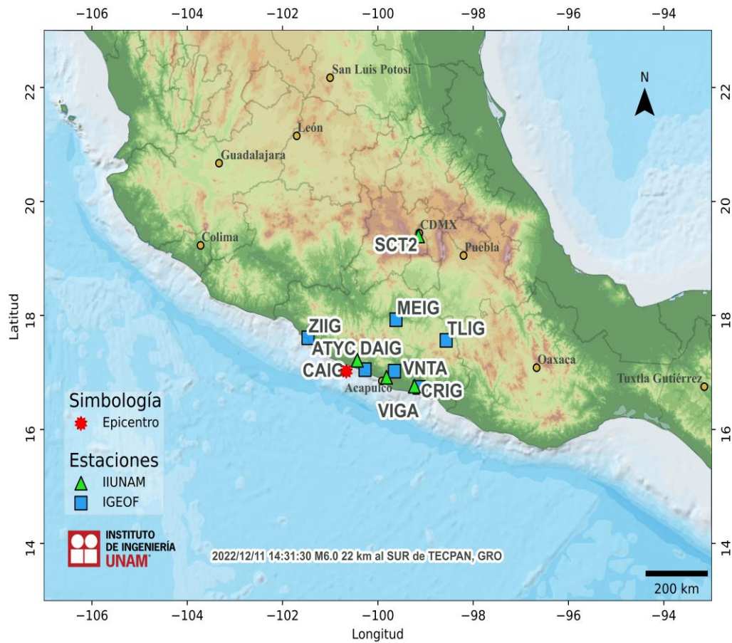
Figura 1. Epicentro del sismo del 11 de diciembre de 2022 (M6.0) y estaciones sísmicas empleadas en la elaboración del mapa preliminar de PGA. Las estaciones pertenecientes a la Red Acelerográfica del Instituto de Ingeniería de la UNAM (IIUNAM) son operadas por la Unidad de Instrumentación Sísmica. Las estaciones IGEOF mostradas son operadas por el Servicio Sismológico Nacional.
