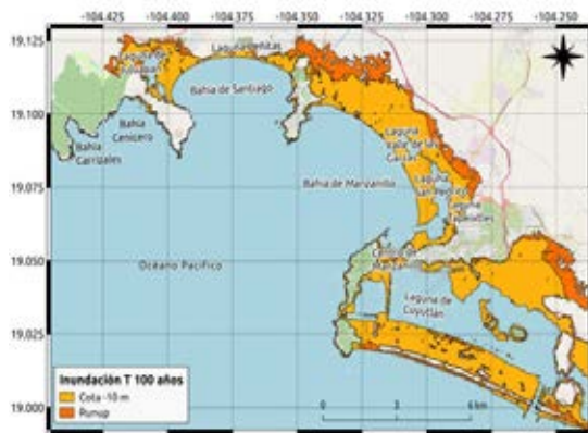
Figura 3. Mapa de inundación para el periodo de retorno de 100 años. Se muestra la inundación usando el valor de sensor ubicado sobre la cota de -10 m y la aproximación del runup
