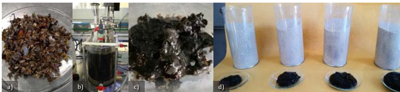
Figura 6. Experimento para mejoramiento de suelo: a) FORSU triturada; b) reactor; c) residuo digerido; d) componentes de arena y sustratos para incubaciones
