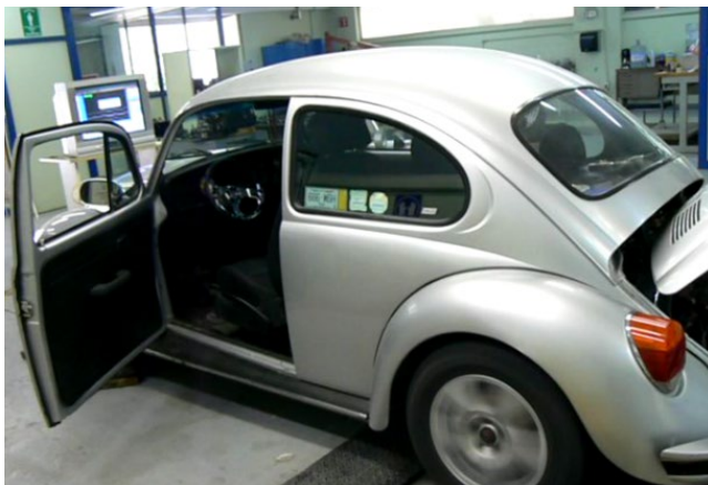
Figura 1. Evaluación vehicular en un dinamómetro de Unidad de Investigación y Control de Emisiones
