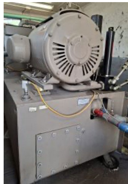
Figura 1 a) Placa con modelo de la Unidad de Potencia, indicadores, botones de paro y encendido. b) Vista trasera de la Unidad de Potencia Hidráulica 506 de MTS
