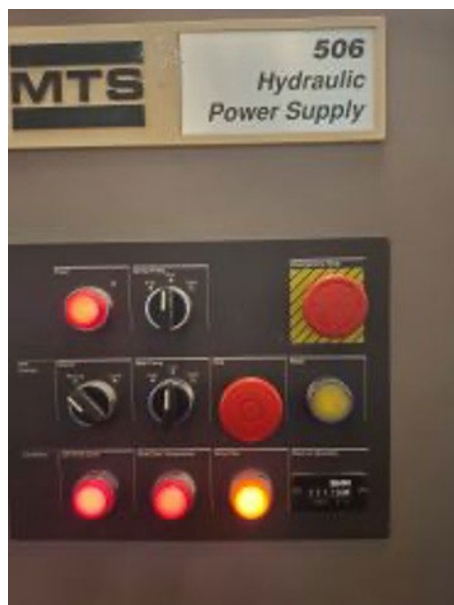
Figura 1 a) Placa con modelo de la Unidad de Potencia, indicadores, botones de paro y encendido. b) Vista trasera de la Unidad de Potencia Hidráulica 506 de MTS
