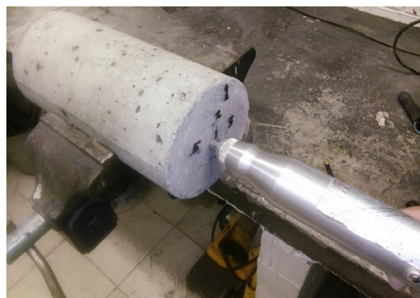
Figura 2. Distribución de puntos de aplicación del esclerómetro y forma de ejecución del ensayo
