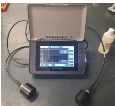
Figura 3. Equipo ultrasónico empleado en el estudio y forma de ejecución del ensayo
