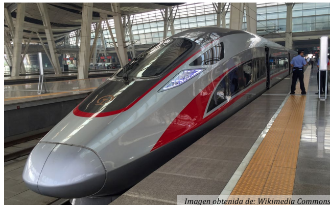
Figura 1. Tren rápido tipo G (350 km/h)
