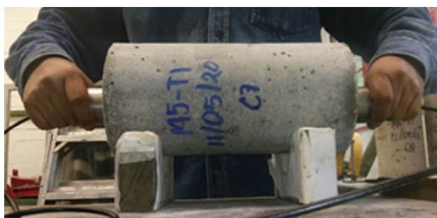
Figura 3. Equipo ultrasónico empleado en el estudio y forma de ejecución del ensayo
