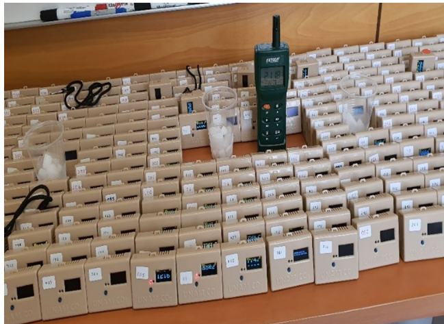
Figura 4. Verificación de los equipos utilizando hielo seco
