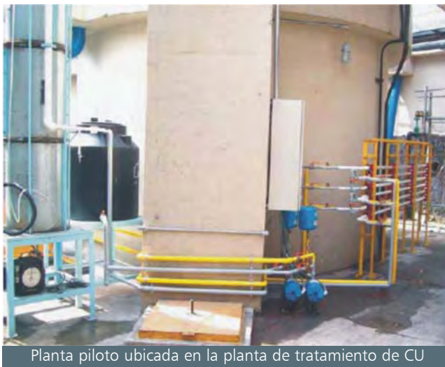
Montaje experimental del reactor anaerobio con membrana
