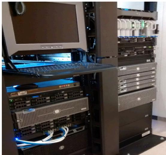
Figura 10.23. Servidores Linux para virtualización y clúster.
