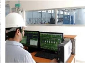
Cuarto de Control de Mando para la visualización de las variables de operación del circuito de pruebas tales como presión, temperatura, viscosidad y flujo. Así mismo se monitorean los niveles de los tanques de fluidos y se controlan las condiciones de operación de las bombas
