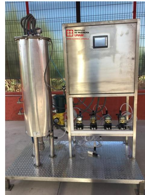
Reactor productor de hidrógeno
