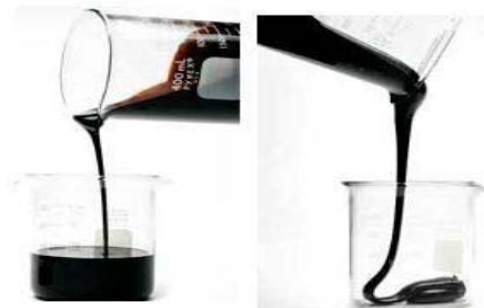
Figura 1. Contraste entre crudos ligeros (alto API y baja viscosidad) y extra-pesados (bajo API y alta viscosidad) (fuente: RBN Energy LLC, 2016).
