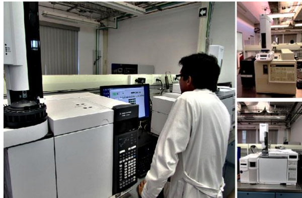
Figura 2. Equipos de cromatografía de gases para el análisis de los contaminantes en fase gaseosa
