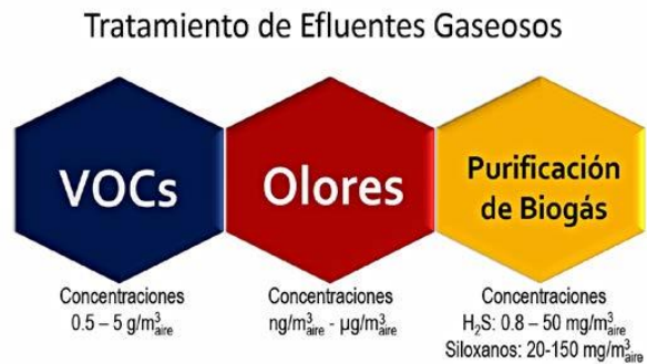
Figura 1. Ejes de la línea de investigación sobre tratamiento de efluentes gaseosos donde se presentan los intervalos de concentraciones típicas de los contaminantes
