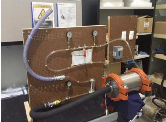
Figura 6. Arreglo de conexión para las pruebas de flujo
