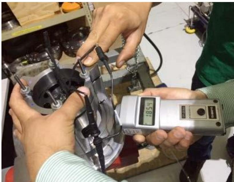
Figura 4. Registro de vibraciones de la microturbina
