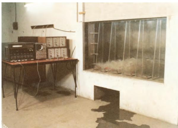
Modelo hidráulico para estudiar el levantamiento de losas de un tanque amortiguador. Archivo histórico del II.
