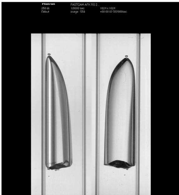
Figura 4. Detalle de la burbuja que no viaja sola. Se observa la pequeña burbuja milimétrica frente a la burbuja de Taylor, ambas viajando de manera estable a gran velocidad
