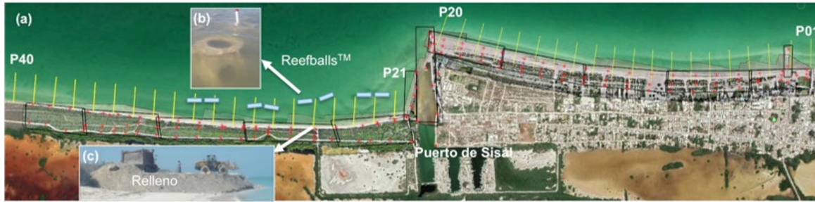
Figura 2. Posición de los perfiles de playa levantados en Sisal (amarillo), los polígonos de los vuelos (cuadros negros y puntos de control en rojo) y la ubicación de los Reefballs™ (líneas en azul claro). Modificada de Franklin et. al. (2021)
